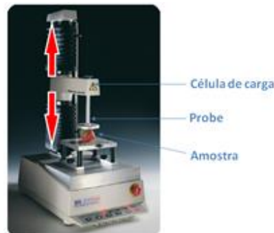
Figura 1 – Divisão de partes do Analisador de Textura Modulado TA. XT. Plus.
